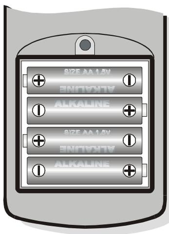
**Depois de substituir as baterias, os parâmetros data, hora, taxa baud, tipo de sonda, intervalo de impressão e registro, devem ser configurados novamente: a fim de simplificar esta operação, ao inserir novas baterias o instrumento liga automaticamente e pede estes parâmetros na seqüência.** Para passar para o próximo item pressione ENTER, para retornar ao modo de medição, pressione MENU
