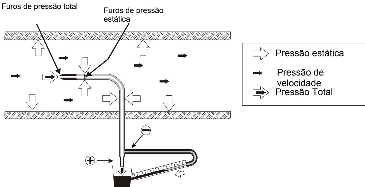
A pressão dentro do duto é o resultado de três diferentes pressões:
