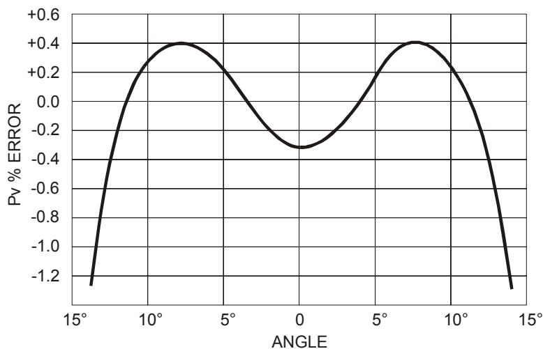
As abscissas mostram o ângulo de rotação sobre seu eixo vertical comparado à direção do fluxo (rotação em torno do eixo vertical), nas ordenadas, a % de erro nas medições de pressão diferencial Pv. Como você pode ver uma diferença acima de 10% acarreta um erro na medição da pressão diferencial Pv de menos de 0,5%.
