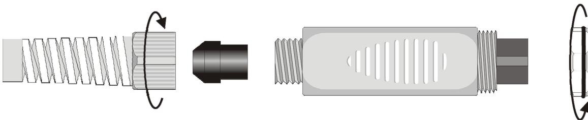
Abrir os dois revestimentos do módulo: o circuito impresso ao qual a sonda deve ser conectada está alojado dentro. Do lado esquerdo existe 1...4 pontos nos quais os fios do sensor devem ser soldados. Os jumpers J1...J4 estão no centro da placa. Estes devem ser fechados com um preenchimento de estanho para cada tipo de sensor.
