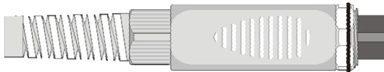
As instruções para conectar a sonda de Platina ou Níquel ao módulo são fornecidas abaixo: O módulo é fornecido completo com guia de cabo e bucha para cabos com diâmetros máximos de 5 mm.
