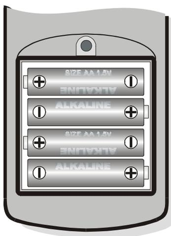
**Depois de substituir as baterias, a data, hora, taxa baud, tipo de sonda, intervalo de impressão, parâmetros de registro, devem ser configurados novamente: a fim de simplificar esta operação, ao inserir novas baterias o instrumento liga automaticamente e pede estes parâmetros na seqüência.** Para ir para o próximo item pressione ENTER, para retornar ao modo de medição, pressione MENU.
