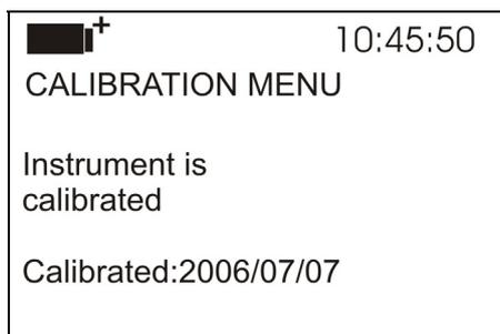
5. Pressionar **ENTER** ou **ESC** para voltar ao menu principal: você não pode alterar nada: **somente o Suporte Técnico pode calibrar o instrumento.**
