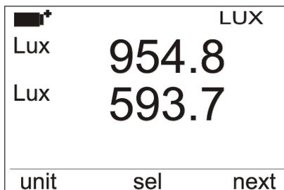
A primeira linha do display mostra a sigla “LUX” indicando a unidade de medição de uma sonda de luminosidade com mudulo SICRAM.
